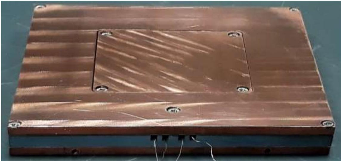
Figure 5 : résistances chauffantes dans son boîtier en cuivre.
