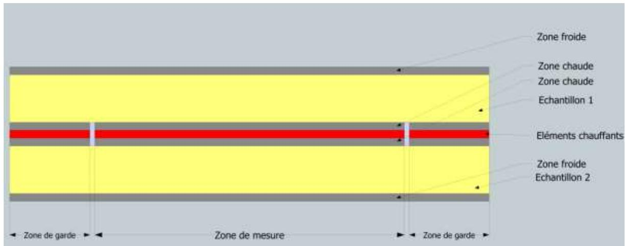
Figure 1 : Schéma de principe de la plaque chaude gardée
